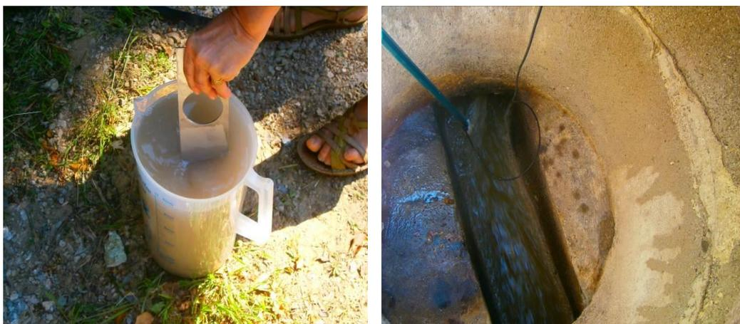
Figure 5. Traçage au sel pour l'estimation du temps de transfert dans le tronçon de Bellecombe. A gauche, préparation de la saumure ; à droite, mesurage de la conductivité.
