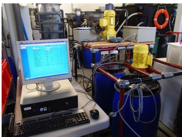
Figure 60. Vue générale des deux pilotes et de l'ordinateur connecté à la centrale d'acquisition de données Sofrel S550 dans la halle d'essais de la Feyssine.
