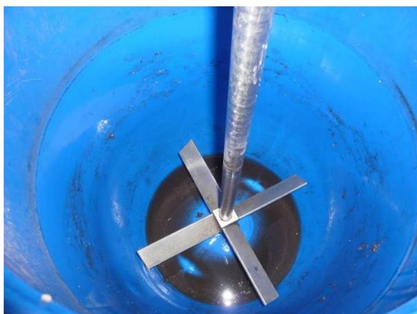
Figure 66. Vue intérieure du fût après essai infructueux de développement d'un biofilm durant 28 jours (22 mars -19 avril 2016).
