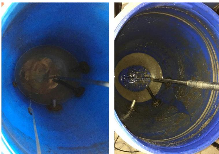
Figure 77. Pilote sans biofilm (à gauche) et avec biofilm (à droite).
