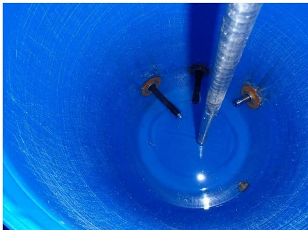
Figure 61. Vue intérieure des capteurs installés en partie basse des pilotes.
