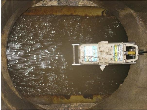
Figure 24. Débitmètre FloDar installé temporairement dans le regard aval OH119 (photos : Michel Enggist, République et Canton de Genève).
