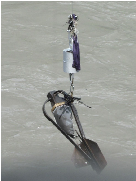
Jaugeage solide sur le Rhône à Bognes (traille) (05/2016)
