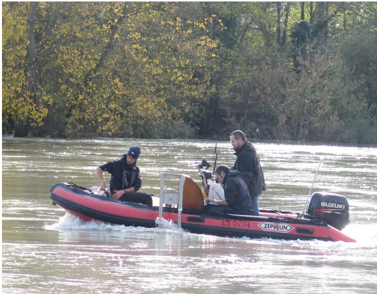
Jaugeage solide sur le Rhône ADCP et prélèvements (2023)
