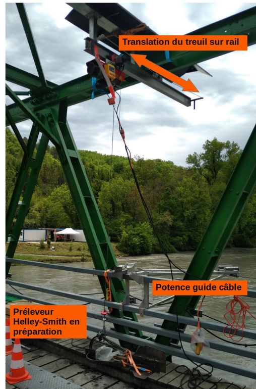
Jaugeage solide sur le Rhône à Pyrimont (pont) (05/2021)
