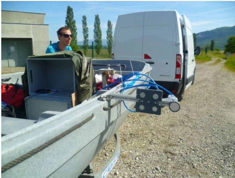
Déploiement de l'Aquascats (ABS multifréquence) Pendant l'APAVER 2026. A. Vergne (2018)
