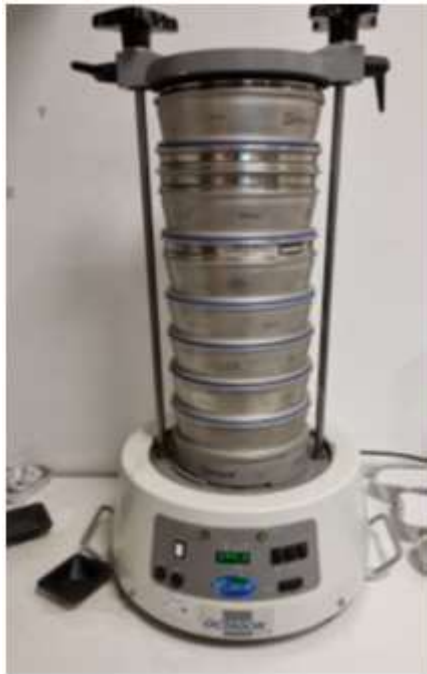
Granulomètre par tamisage
