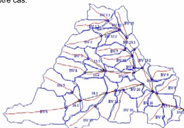
Figure 2. Construction du modèle hydrologique distribué de l'Yzeron. Base modèle CANOE (INSA-SOGREAH) (B. Radojevic, 2002).
