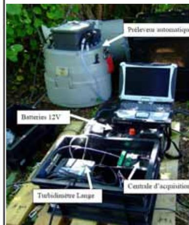
Dispositif de suivi des particules fines sur le ruisseau de la Chaudanne (Barra, 2009)
