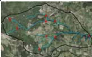
Un réseau de 15 limnimètres sur le bassin du Mercier (7 km<sup>2</sup>) à pas de temps 2min durant 3 ans
