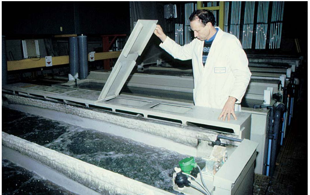
Figure 17. Dispositif d'aspiration latérale muni d'une trappe de visite.
