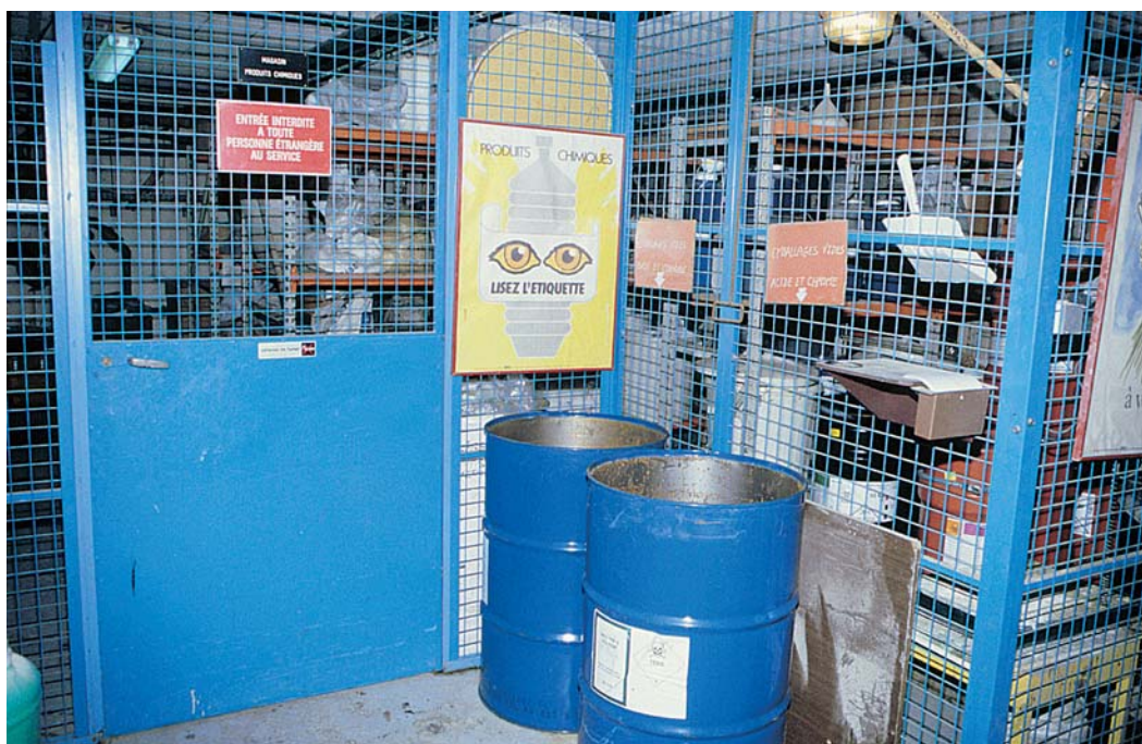
Figure 13. Exemple de local fermé pour le stockage de produits dangereux.
