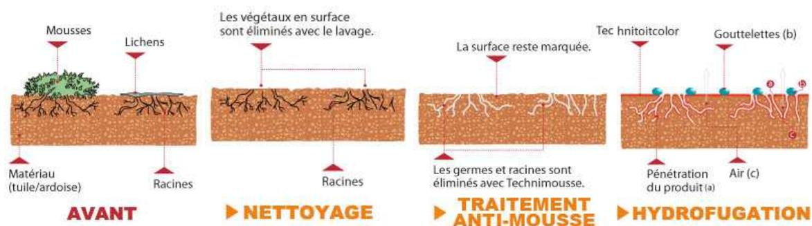
Figure 1 : Techniques utilisées pour le lavage des toitures et leurs actions
