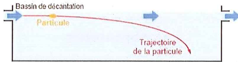
Schéma d'un décanteur horizontal
