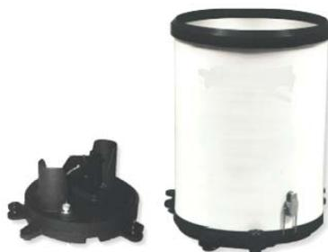
Illust. 2: Pluviographe à augets basculants
