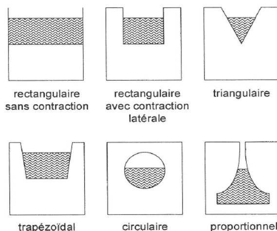
**Figure 1 :** Géométries des différents seuils (Voir Norme A311)
