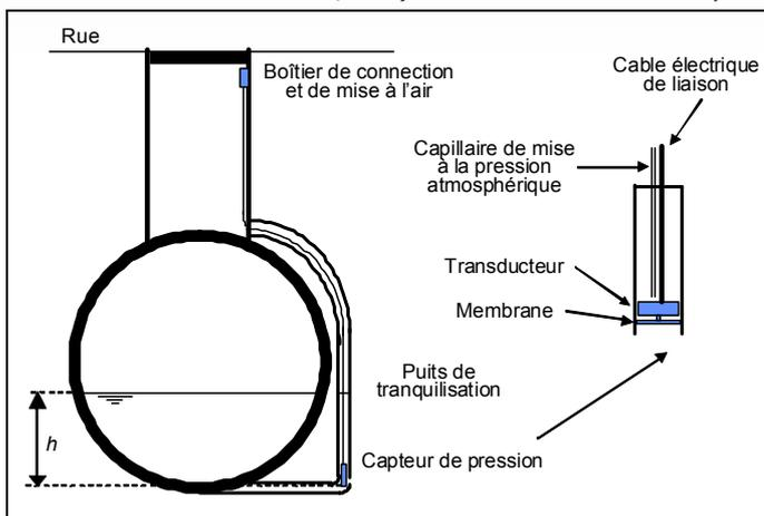
Fig.1: Schéma de Principe issu de l'ouvrage
