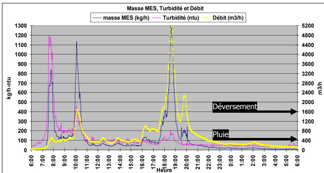
Figure 1: Débit massique de MES, turbidité ou concentration équivalente en MES et débit volumique, pendant une pluie (débit > 400 m<sup>3</sup>/h) avec 3 déversements (débit >1600 m<sup>3</sup>/h), dans le réseau unitaire d'Ecully au niveau d'un déversoir d'orage (Source: OTHU).
