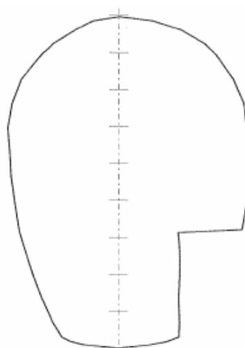
Figure 4.1 : section du collecteur type 064 à banquettes
