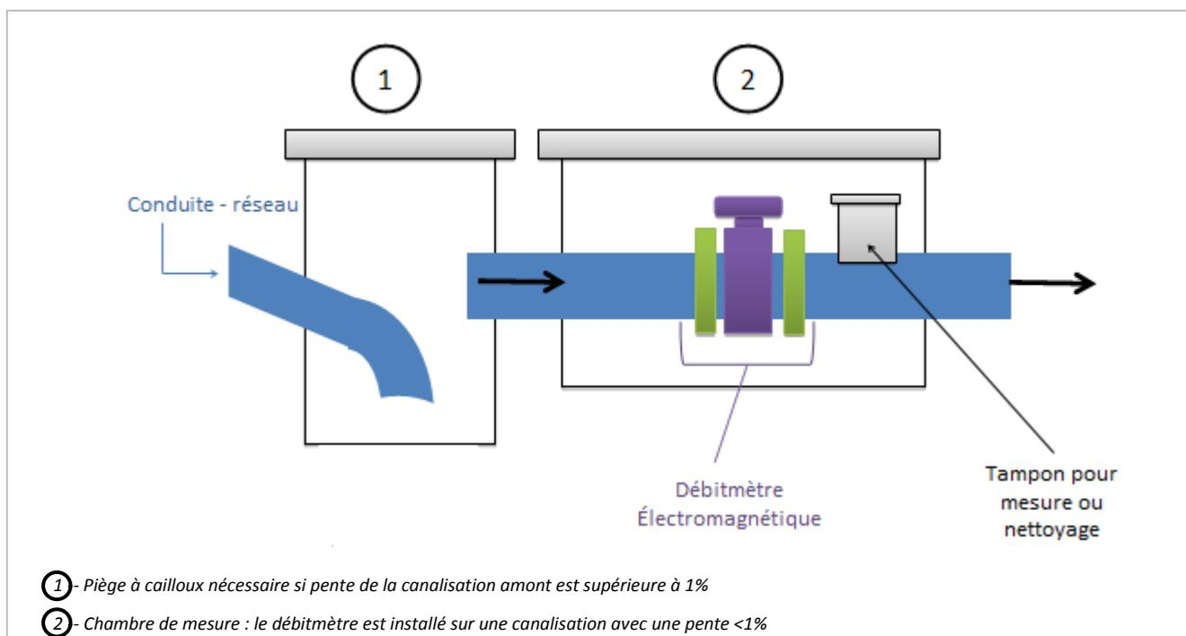
*Illust. 1: Exemple de Chambre de mesure Type*
