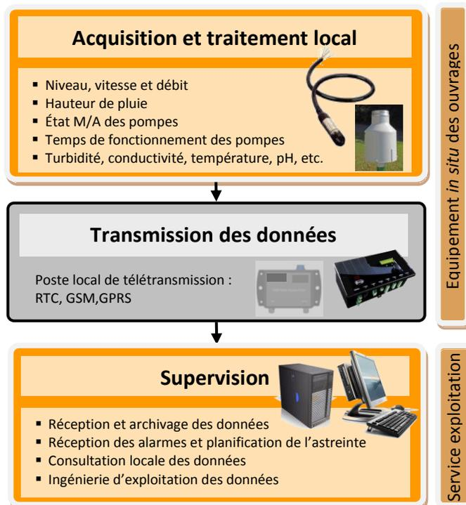
Sont décrits principalement dans cette fiche, les éléments essentiels de l'acquisition et de la transmission de données : les fréquences de mesure (scrutation) et d'enregistrements (historisation), puis les différents modes de transmission de données avec leurs avantages et inconvénients respectifs. Le volet supervision « validation et valorisation des données d'autosurveillance » est traité dans une fiche technique dédiée.
