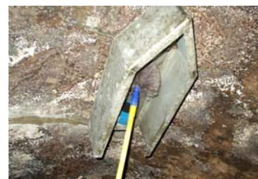
*Illust. 3: nettoyage d'une sonde installée en voûte
