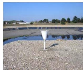
Illust. 3: Pluviographe à augets basculants
