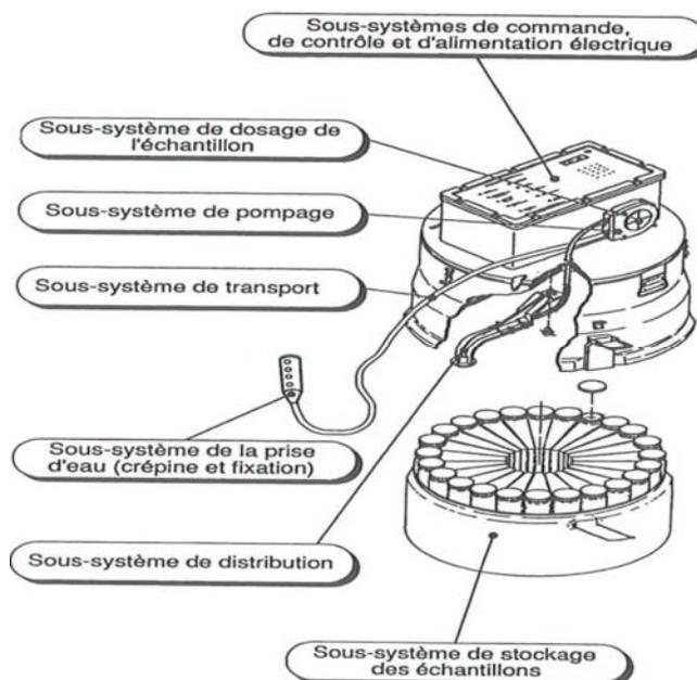
Fig. 1: Les sous-systèmes d'un préleveur portable
