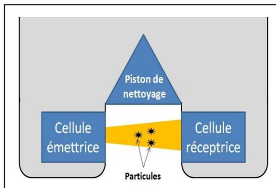
Figure 2: Turbidimétrie par transmission
