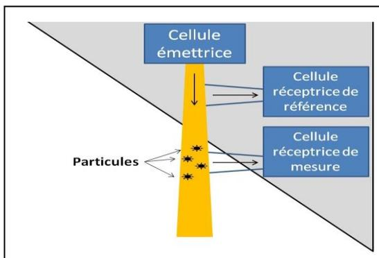
Figure 1: Turbidimétrie par diffusion
