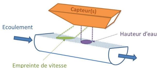
Fig. 1: Principe de mesurage de la vitesse et de la hauteur par radar
