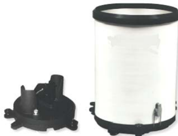
Illust. 2: Pluviographe à augets basculants (Hydreka PL2)
