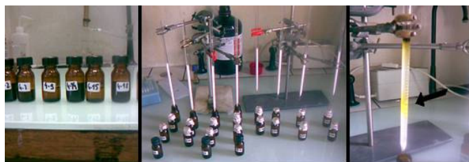
Figure 3: La Purification. De gauche à droite: les extraits à l'issue de l'évaporation au rotavapor, les colonnes de gel de silice, fraction HAP en train d'être éluee
