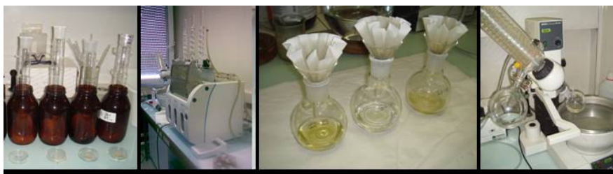
Figure 2: L'extraction. De gauche à droite: préparation des matras, le Soxhlave, récupération des échantillons sur filtre plissé, évaporation au rotavapor
