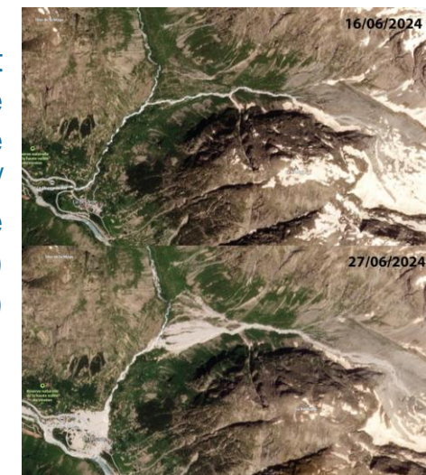
Élargissement du lit dans le torrent de l'Etançon/Bonne Pierre (Ecrins) (Juin 2024)
