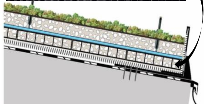
Système d'arrosage par aspersion et dalles alvéolaires pour pente forte
