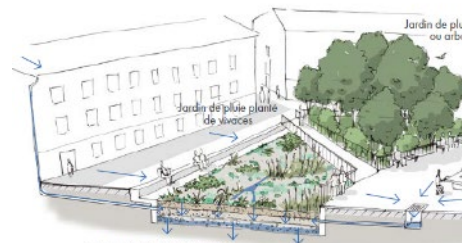
Strates drainantes de haut en bas : sables, cailloux et géotextiles (granulométrie croissante)
